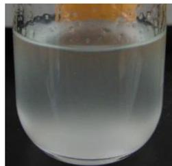
水溶性アクリルモノマー、架橋剤、UV重合開始剤の入った水溶液。この水溶液にUV照射すると延性に富むゲルができる。□
