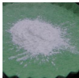
水中で膨らむと硬くて脆くなる吸水性ゲルの乾燥粉末□
