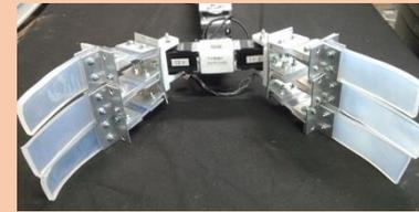
ゲル材料のロボットハンドへの応用
